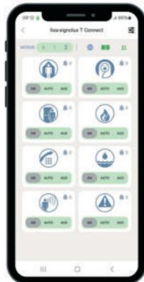
Der neue **Empfänger T-Connect** für Ihre häusliche Signalisierungsanlage **lisa-signolux** macht Ereignisse durch auffällige Lichtsignale und kräftige Töne unübersehbar. Gleichzeitig verbindet er sich drahtlos mit dem Router und leitet Meldungen ins Mobilfunknetz weiter.
